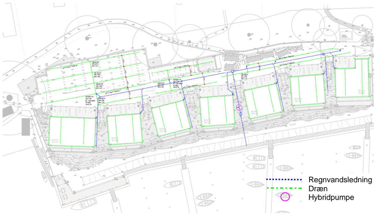
Figur E. Håndtering af opstuvende grundvand via netdræn. OBS: Foreløbig situationsplan over område. Der tages forbehold for ændringer.
